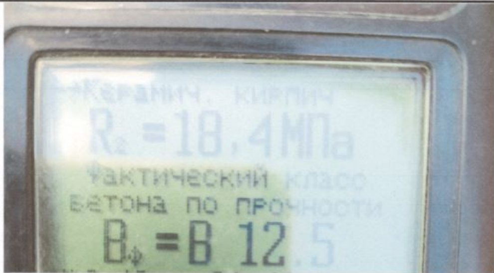
Фактическая прочность кирпичной кладки.
